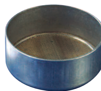
Pot de granulés* Ø intérieur 97 mm Hauteur intérieure 40 mm
